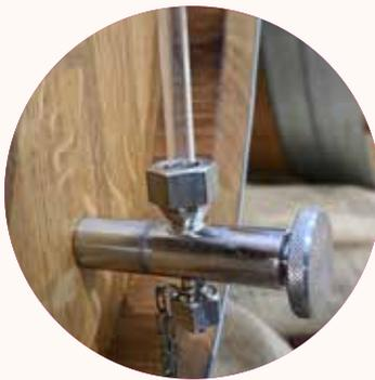
Füllstandsanzeige mit Füll-
